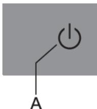
**Включение прибора.** Чтобы включить прибор, нажмите кнопку A и удерживайте 2 секунды.
