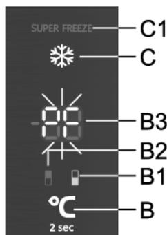
При отключении электроэнергии температура внутри прибора может превысить допустимый уровень. В этом случае после возобновления электроснабжения включится сигнализация о превышении допустимой температуры. Раздастся звуковой сигнал, и на дисплее **B3** начнет мигать индикация «PF».
