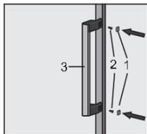
Примечание. Если ваш прибор оборудован ручкой, ее необходимо переставить на противоположную сторону, следуя приведенным ниже инструкциям.
