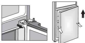
Открутите винты, фиксирующие средний шарнир, и снимите шарнир. Снимите нижнюю дверцу с нижнего шарнира.
