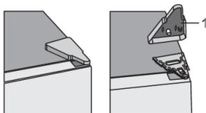
Управление внутри прибора: Снимите крышку верхнего шарнира (1).
