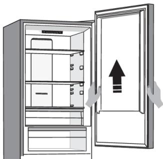
Приподнимите верхнюю дверцу и аккуратно снимите со среднего шарнира. Положите дверцу на ровную поверхность.
