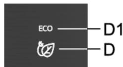
**Включение.** Чтобы включить режим «Есо», коротко нажмите кнопку **D**. Загорится индикатор **D1**. В экономичном режиме прибор работает с оптимальными настройками.
