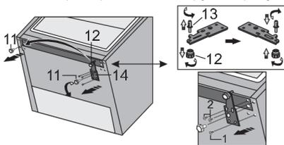
Открутите три винта, фиксирующие нижний шарнир (14), и снимите шарнир. Снимите ножку (12) со стержня нижнего шарнира (13). Открутите стержень (13) нижнего шарнира, переставьте на обратную сторону шарнира и прикрутите вместе с ножкой (12).
