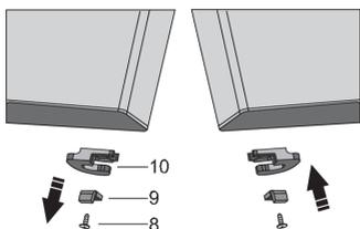
Открутите винт (8), снимите ограничитель двери (10) и упор двери (9). С помощью винта (8) прикрутите ограничитель двери, прилагаемый в пакете, и упор двери (9). Уберите ограничитель двери (10) на случай, если он понадобится в будущем.
