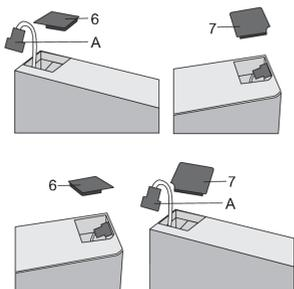
Управление на двери прибора: Снимите крышку (6) с левой стороны верхней дверцы и извлеките коннектор (А). Затем снимите крышку (7) с правой стороны верхней дверцы. Установите крышку (7) с левой стороны верхней дверцы и крышку (6) с правой стороны.
