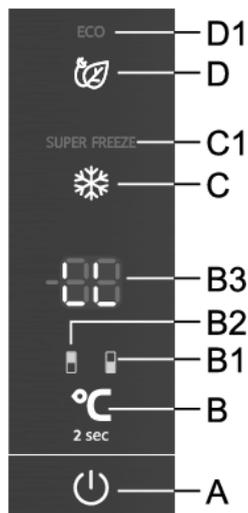
**Включение.** Чтобы включить защитную блокировку, нажмите и удерживайте две секунды кнопки **A** и **D**. На дисплее **V3** на некоторое время загорится индикация «LL».
