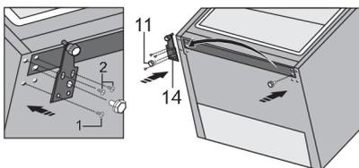
13. Установите шарнир (14) с противоположной стороны прибора и зафиксируйте винтами. Винты необходимо прикручивать в порядке, показанном на рисунке ниже. Сначала затяните винт 1, затем винты 2. После этого прикрутите регулирующую ножку (11).
