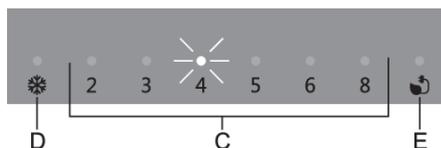
Если температура внутри прибора превышает допустимое значение, включается прерывистый звуковой сигнал и мигает индикатор **(С)** над установленной температурой.
