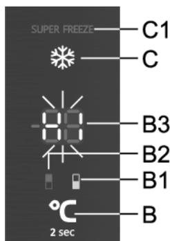
Если температура внутри прибора превышает допустимое значение, включается прерывистый звуковой сигнал. На дисплее **B3** начинает мигать индикация «HI», и загорается индикатор отделения, в котором превышена температура (**B1** или **B2**).
