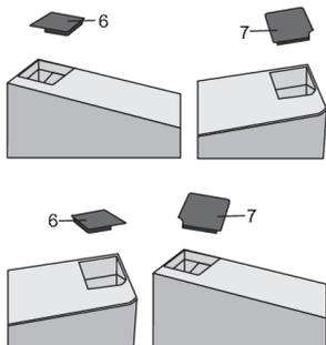
Управление внутри прибора: Снимите крышку (6) с левой стороны верхней дверцы. Затем снимите крышку (7) с правой стороны верхней дверцы. Установите крышку (7) с левой стороны верхней дверцы и крышку (6) с правой стороны.
