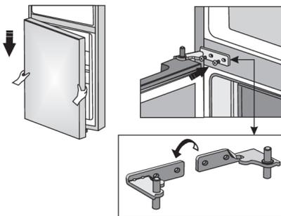
Установите нижнюю дверцу на нижний шарнир и придерживайте в этом положении. Переверните средний шарнир на 180°. Установите шайбу в правильное положение и отрегулируйте положение среднего шарнира, чтобы установить и закрепить нижнюю дверцу.
