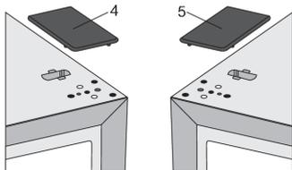
Возьмите из пакета (правую) крышку (4) и закройте отверстия, образовавшиеся после снятия шарнира. Снимите и уберите в пакет крышку (5) с левой стороны, где будет устанавливаться шарнир.
