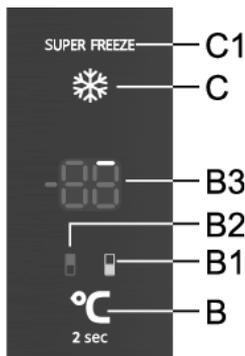
Чтобы включить «Быстрое замораживание», нажмите кнопку **C**. Раздастся звуковой сигнал, и загорятся индикаторы **B1** и **C1**.
