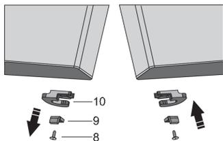
Положите нижнюю дверцу на ровную поверхность. Открутите винт (8), снимите ограничитель двери (10) и упор двери (9). С помощью винта (8) прикрутите ограничитель двери, прилагаемый в пакете, и упор двери (9). Уберите ограничитель двери (10) на случай, если он понадобится в будущем.
